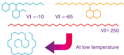
شکل ۱: تاثیر ساختار مولکولی بر شاخص گرانروی
