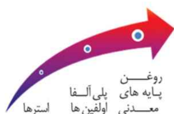
شکل ۶: مقایسه فراریت انواع روغن پایه‌ها
