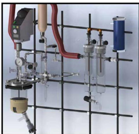
شکل ۲- نمایی از تجهیزات مورد نیاز برای انجام آزمون ROBO
