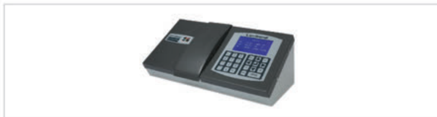
شکل ۱- دستگاه اندازه گیری خودکار رنگ به روش های ASTM D1500 و ASTM D156
