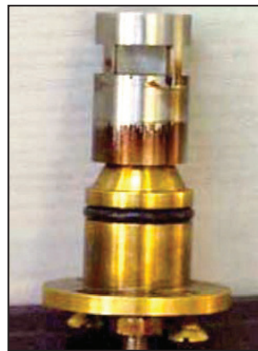
شکل شماره ۱. یک شیر را نشان می‌دهد که به دلیل تشکیل لجن به هم چسبیده است.
