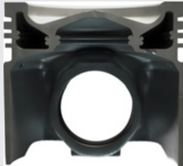
شکل شماره ۱. تصویر پیستون فولادی استفاده شده در موتور دایملر OM471 خودروهایی دیزلی سنگین.
