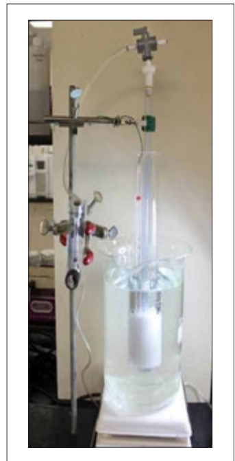
شکل شماره ۳. ارزیابی کف کردن یک مایع انتقال حرارت بر پایه آب/گلیکول با استفاده از روش آزمون ASTM D1881
