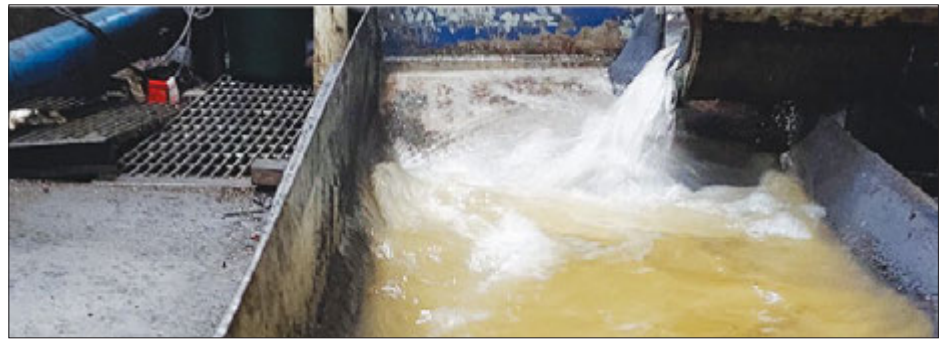
شکل شماره ۹. روغن سنتزی حل شونده پرمصرف ترین سیال سنتزی است که پایه اولیه آن آب است.
